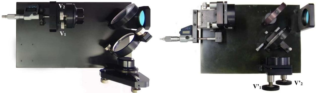
3.2.2. Vers le contact optique et la teinte plate : diminuer l'épaisseur  $e$  de la lame d'air
