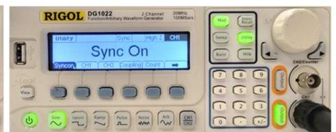
⚠ Synchronisation de l'oscilloscope et du GBF – Utilisation d'une synchronisation externe
