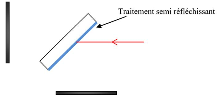
Cette dissymétrie entre les deux voies pose problème car l'indice du verre dépend de la longueur d'onde  $\lambda$ . Dans cette configuration, il est impossible de repérer une frange centrale (différence de marche nulle) en lumière blanche. D'où la nécessité d'une lame compensatrice du même verre, de la même épaisseur et parallèle à la séparatrice.
